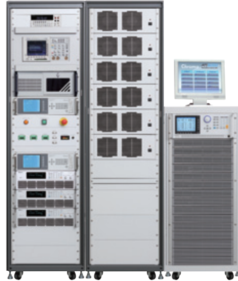
PV Inverter ATS
